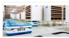
SISTEMA ROBOTIZADO DE PREPARACIÓN DE PEDIDOS
